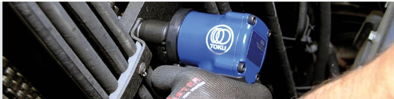
Der Schlagschrauber ist das bekannteste Druckluftwerkzeug. Er wird praktisch überall eingesetzt (in Werkstätten, Schiffsbau, Petrochemie und Industrie), wo viele Schrauben oder Muttern gelöst oder angezogen werden müssen. Schlagschrauber gibt es in verschiedenen Ausführungen, gerade, Pistolen- und Winkelform, und in verschiedenen Größen, 3/8"- bis 2 1/2"-Antriebsvierkant.
